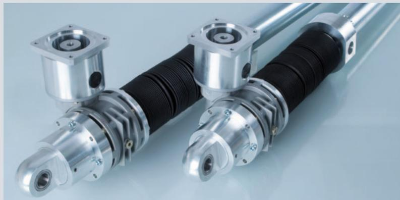
Sonderausführung mit kundenspezifischem Motorflansch: Um die Knickgefahr zu reduzieren, sind die Befestigungsaugen so nahe wie möglich beieinander angebracht. Die Spindelmutter ist vorgespannt und bleibt über die definierte Lebensdauer spielarm.
