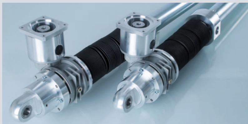
Réalisation spéciale avec flasque moteur spécifique client pour réduire le risque de flambage les alésages de fixation ont été rapprochés le plus possible les uns des autres. L'écrou de la vis est pré-tendu et reste à faible jeu pour la durée de vie définie.
