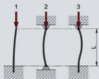
Im Diagramm (Sicherheit 1) mit dem entsprechenden Lastfall (1 / 2 / 3) den Schnittpunkt von Knickkraft  $F$  und freier Spindellänge  $L$  bestimmen. Der Schnittpunkt muss unterhalb der Grenzlinie des gewählten Spindel-durchmessers liegen. Trifft dies nicht zu, ist eine grössere Spindel respektive das nächst grössere Getriebe auszuwählen.
