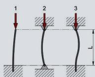
Im Diagramm (Sicherheit 1) mit dem entsprechenden Lastfall (1 / 2 / 3) den Schnittpunkt von Spindel-drehzahl und freier Spindellänge  $L$  bestimmen. Der Schnittpunkt muss unterhalb der Grenzlinie des gewählten Spindel-durchmessers liegen. Trifft dies nicht zu, ist eine grössere Spindel respektive das nächst grössere Getriebe auszuwählen.
