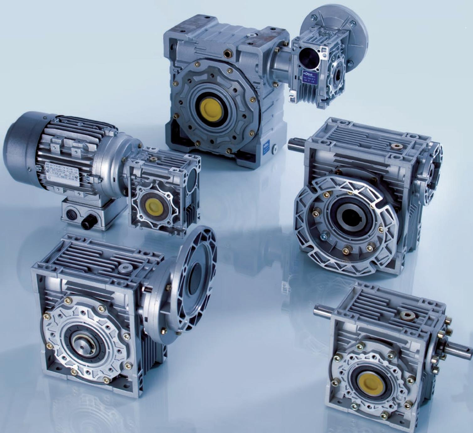
Die Schneckengetriebe der Firma Nozag AG weisen eine quadratische Form auf und sind durch eine hohe Vielseitigkeit der Montage gekennzeichnet. Die Bearbeitung der Bauteile erfolgte mit NC-Maschinen und garantiert höchste Präzision der engen Toleranzen. Die Baugruppen weisen Aluminiumgehäuse in den Grössen 025 bis 090 auf, während die Grössen 110 und 130 Gusseisengehäuse besitzen. Alle Gehäuse werden aluminiumfarben in RAL 9022 lackiert, um die Teile vor Alterung zu schützen.
