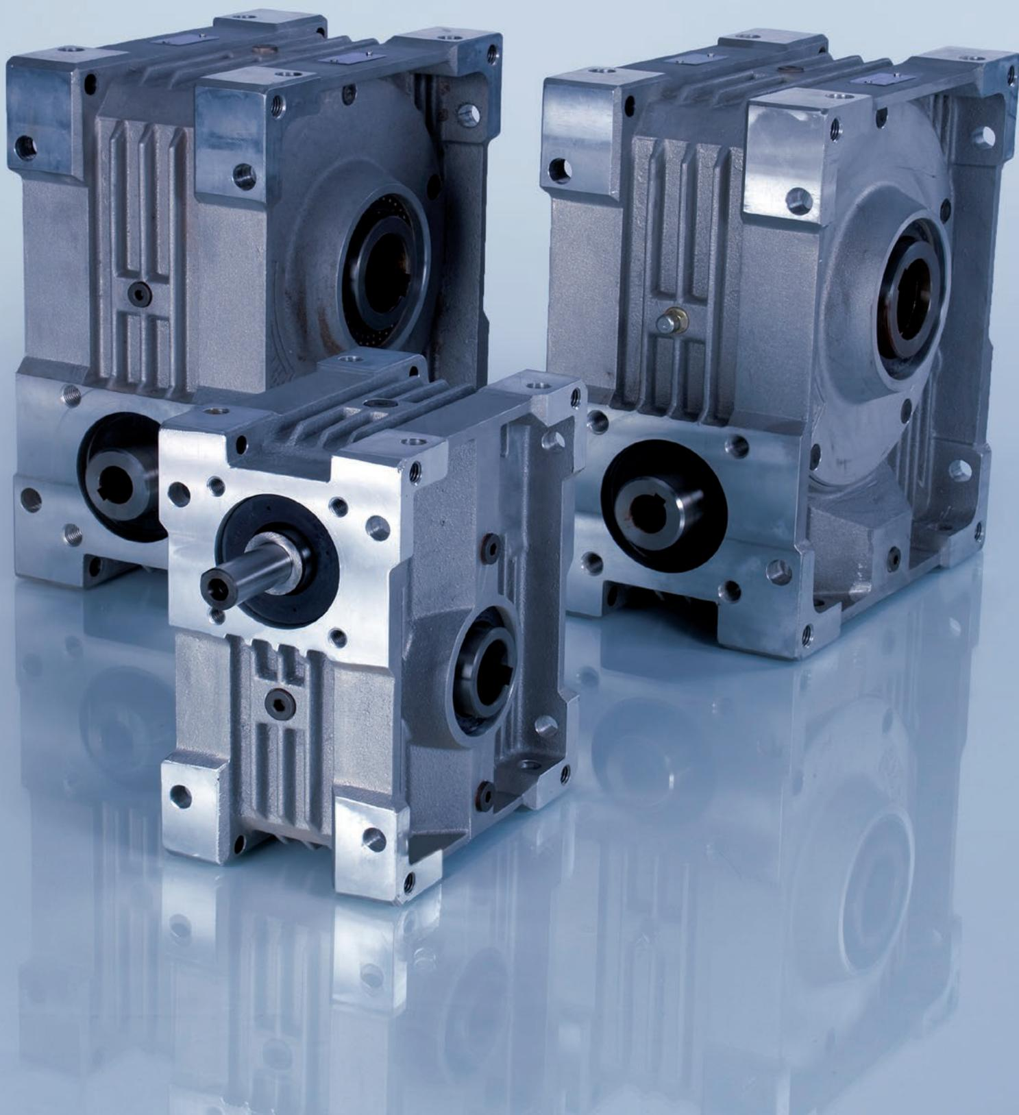
Schneckengetriebemotoren – die neue Verbindung zwischen qualitativ hochwertigen Norm-Schneckengetrieben mit Abtriebs-Hohlwelle und robusten Drehstrommotoren. Untersetzungen von 6,75 bis 82 in sechs Getriebegrößen decken einen Leistungsbereich von 0,12 bis 11 kW ab. Das allseitig bearbeitete Leichtmetall-Gehäuse mit seinen 28 Befestigungs- und Gewindebohrungen gewährleistet ein Montieren der Getriebe in jeder beliebigen Lage, eine Ausführung mit Abtriebsflansch ist ebenfalls möglich.
