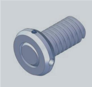
Die Ausdrehsicherung verhindert das Herausdrehen der Spindel aus dem Getriebe. Besonders empfohlen bei Kugelgewindetrieb. Nicht als Anschlag verwenden.
