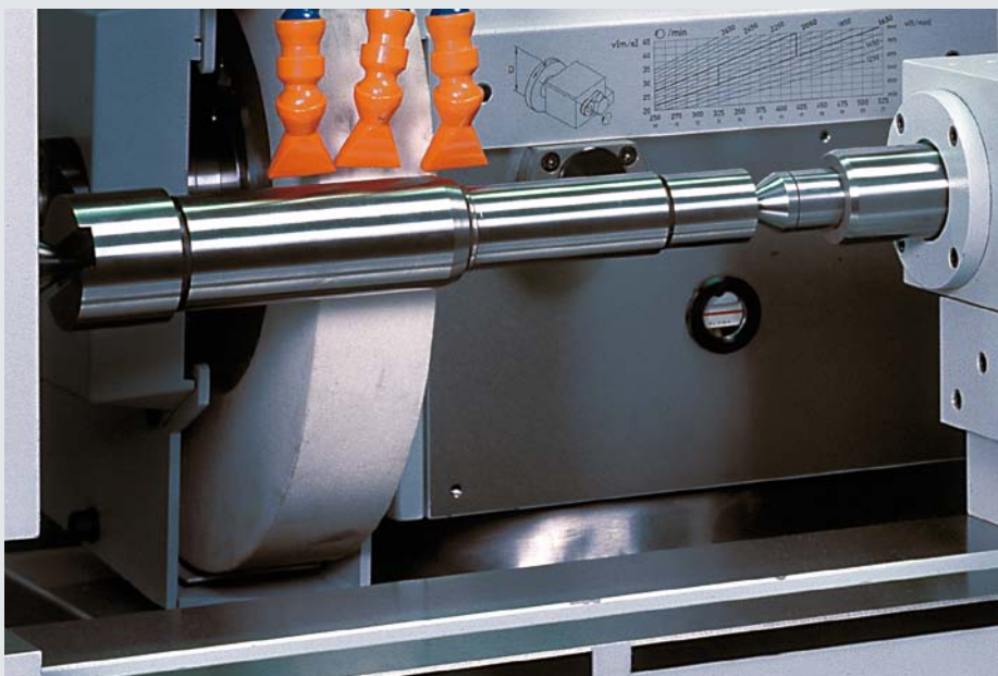
Weiterbearbeitung einer Präzisionswelle auf einer Schleifmaschine usinage complémentaire d'un arbre de précision sur une rectifieuse Further processing of a precision shaft on grinding machine
