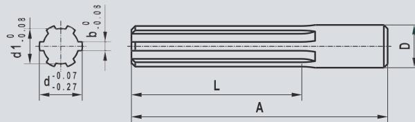
aus Vergütungsstahl C45 ZW gefräst DIN 9611 / ISO 14
