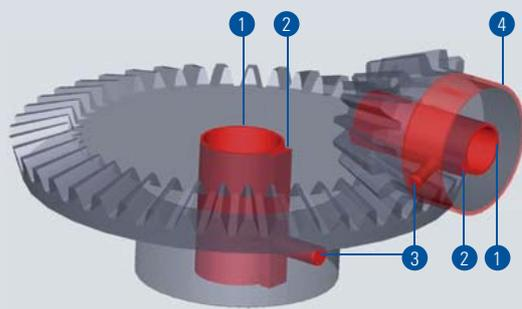
1 Bohrung grösser? 2 Keilnute? 3 Gewindebohrung? 4 Nabe abdrehen?
