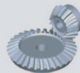
aus 42CrMo4, 1.7227 – spiralverzahnt, Verzahnungsqualität 8, Zylo-Palloid-Verz., Zahnflanken induktiv gehärtet, Übersetzung 1:1 – 1:4, Lieferung nur paarweise
