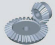
aus 42CrMo4, 1.7227 – spiralverzahnt, Verzahnungsqualität 8, Zylo-Palloid-Verz., Zahnflanken induktiv gehärtet, Übersetzung 1:1 – 1:4, Lieferung nur paarweise
